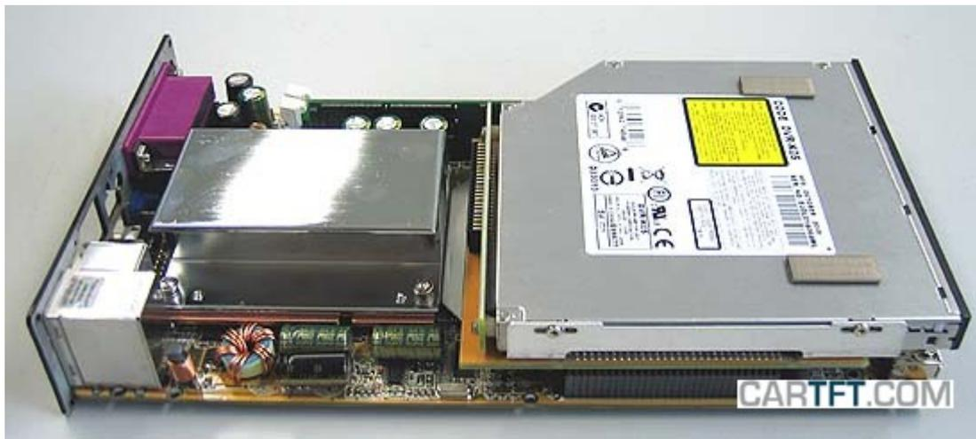
Bevor das Mainboard wieder in das Gehäuse eingeschoben wird, muss am Gehäuse noch die „Laufwerk“-Attrappenblende entfernt werden, damit später das richtige CD/DVD-Laufwerk benutzt werden kann.
